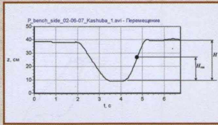
Рис. 2. Пример временной развертки вертикального перемещения ЦТГШ. Черная точка — момент достижения максимальной скорости подъема
